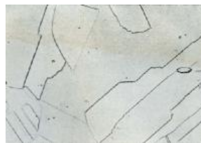
Рис. 44. Микроструктура аустенита, \times 500
