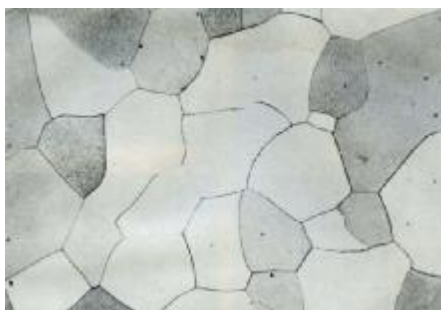
Рис. 42. Микроструктура феррита, \times 500
