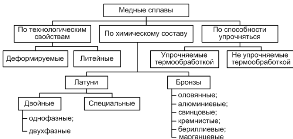
Рис. 82. Классификация медных сплавов
