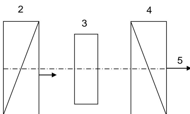
Рис. 12.5. Схема расположения поляризаторов 2, 4 и кристаллической пластинки 3
