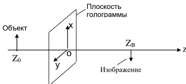
Рис. 10.3. Объяснение обозначений, используемых в формуле (10.4)
