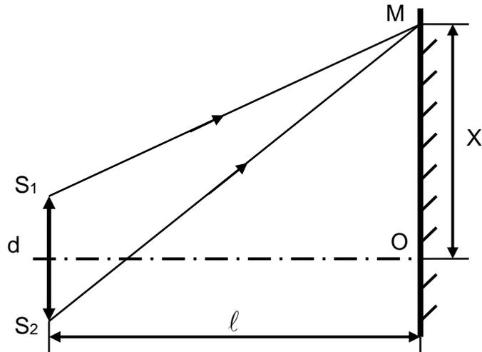
Рис. 3.1. К интерференции Юнга:  $S_1$  и  $S_2$  – когерентные источники света с длиной волны  $\lambda$ ;  $d$  – расстояние между источниками света;  $l$  – расстояние от источников до экрана
