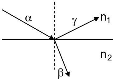
где  $\alpha$  – угол падения луча;  $\gamma$  – угол отражения луча (рис. 1.1).
