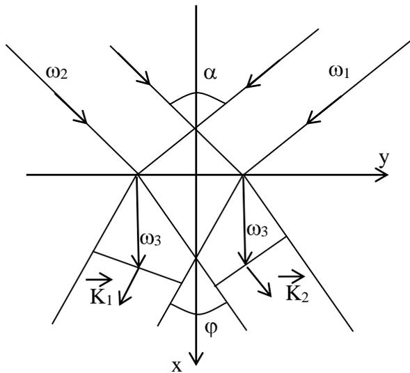
Рис. 11.1. Векторная генерация оптических гармоник:  $\omega_1, \omega_2$  – частоты световых волн, падающих на кристалл;  $\vec{K}_1, \vec{K}_2$  – их волновые векторы;  $\varphi$  – угол между волновыми векторами  $K_1$  и  $K_2$  в кристалле  $\omega_3 = \omega_1 + \omega_2$ ;  $\omega_1 = \omega_2$
