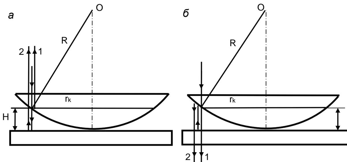
Рис. 3.3. Кольца Ньютона: а – в отраженном свете; б – в проходящем свете
