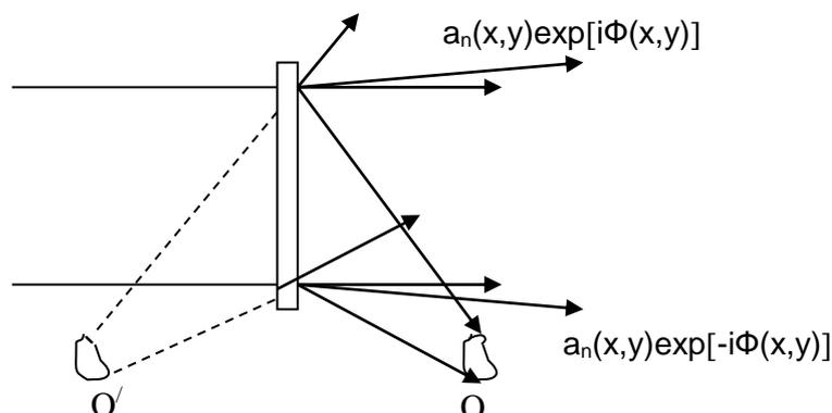
Рис. 10.2. Геометрическая иллюстрация волновых полей за голограммой при восстановлении поля световой волны, рассеянной объектом
