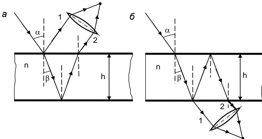
Рис. 3.2. Интерференция в тонких пленках: а – в отраженном свете; б – в проходящем свете;  $h$  – толщина пленки;  $n$  – абсолютный показатель преломления пленки;  $\alpha$  – угол падения;  $\beta$  – угол преломления
