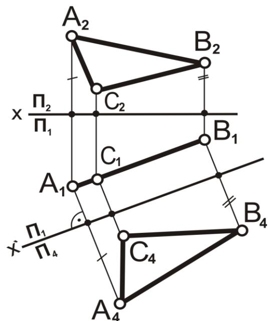
Рис. 6.5. Преобразование плоскости проецирующей в плоскость уровня методом замены
