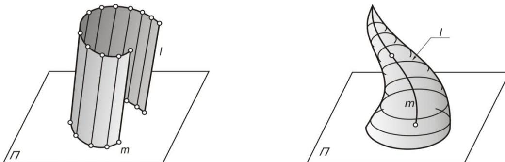
Рис. 7.1. Элементы поверхностей:  $l$  – образующая;  $m$  – направляющая
