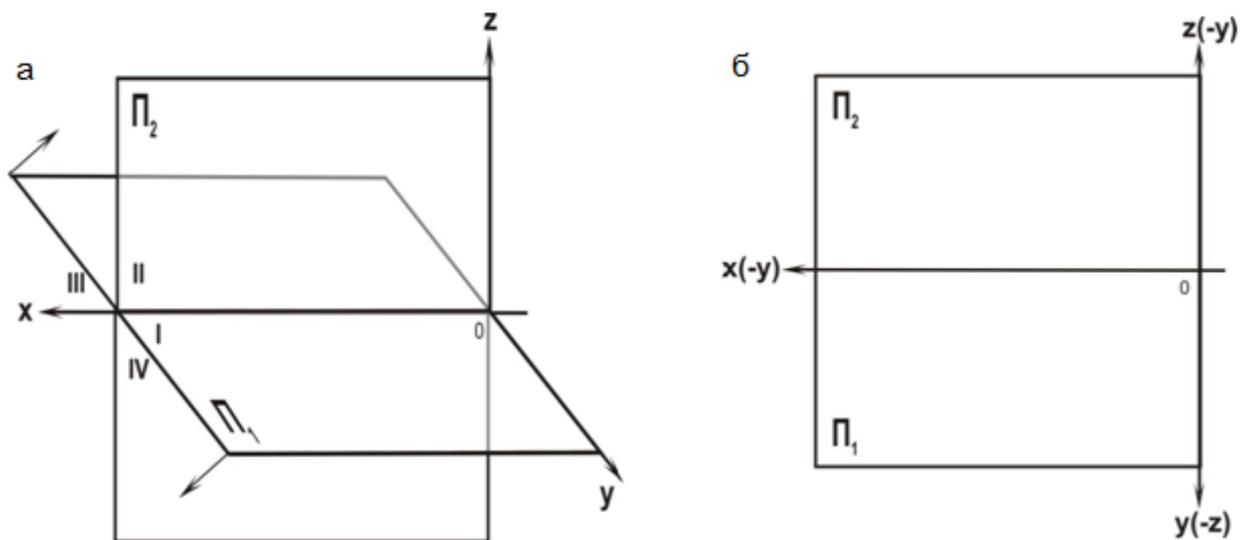
Рис. 2.1. Система плоскостей проекций  $\Pi_1\Pi_2$ : а – наглядное изображение; б – эпюр Монжа
