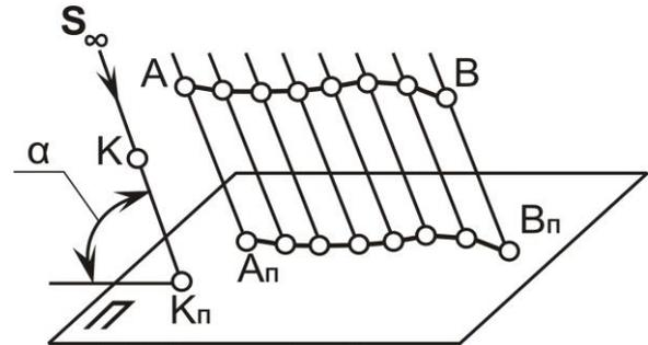
Рис. 1.3. Параллельное проецирование
