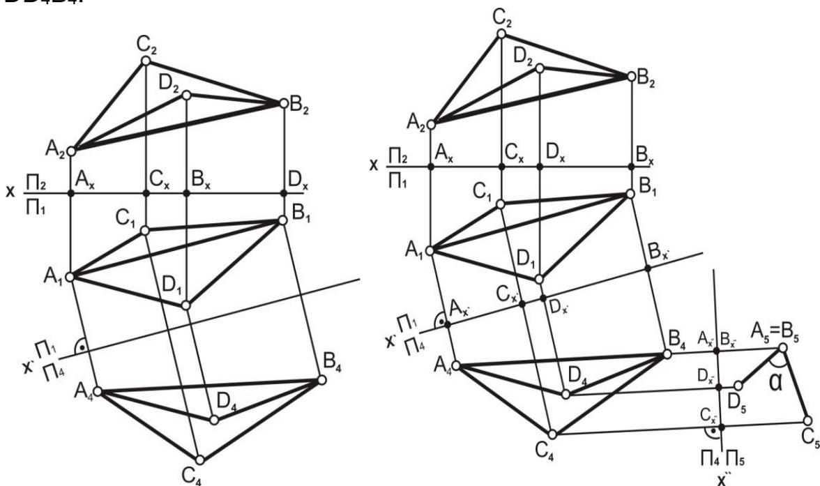
Рис. 6.26. Первая замена плоскостей Рис. 6.27. Вторая замена плоскостей
