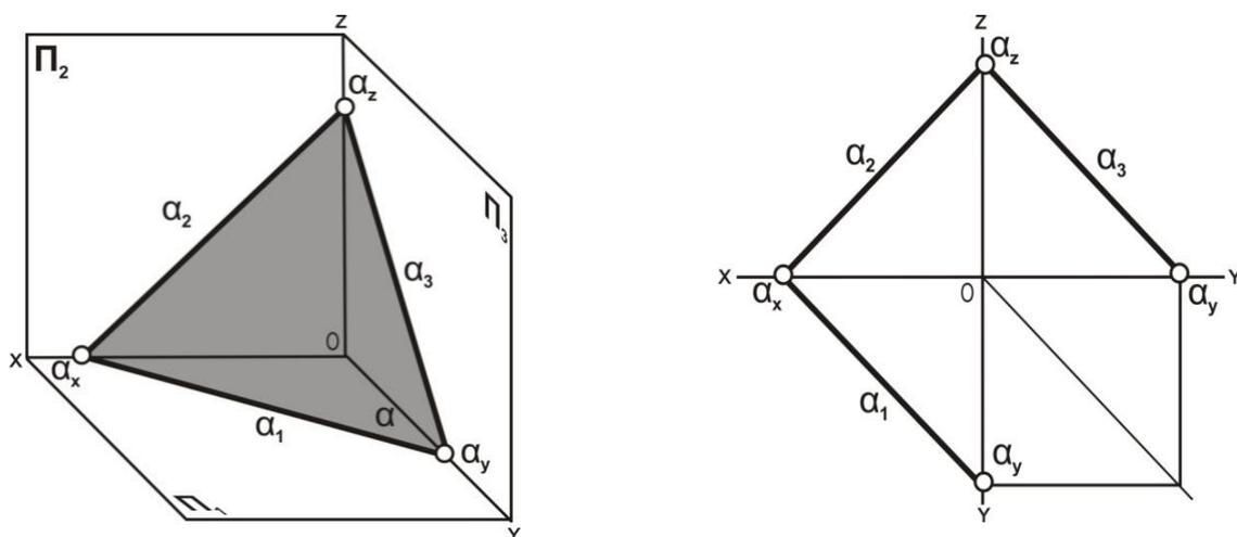
Рис. 5.6. Плоскость задана следами  $\alpha_1$ ,  $\alpha_2$ ,  $\alpha_3$ : наглядное изображение и комплексный чертёж
