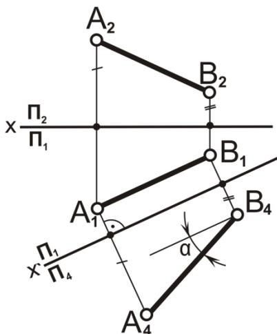
Рис. 6.2. Преобразование прямой общего положения в прямую уровня методом замены плоскостей проекций линией.
