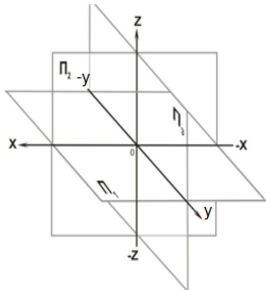
Рис. 2.3. Наглядное изображение совмещенной системы координатных осей X, Y, Z и системы плоскостей проекций  $\Pi_1\Pi_2\Pi_3$
