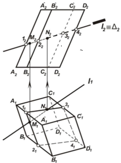
Рис.7.26. Геометрические построения к задаче 12а
