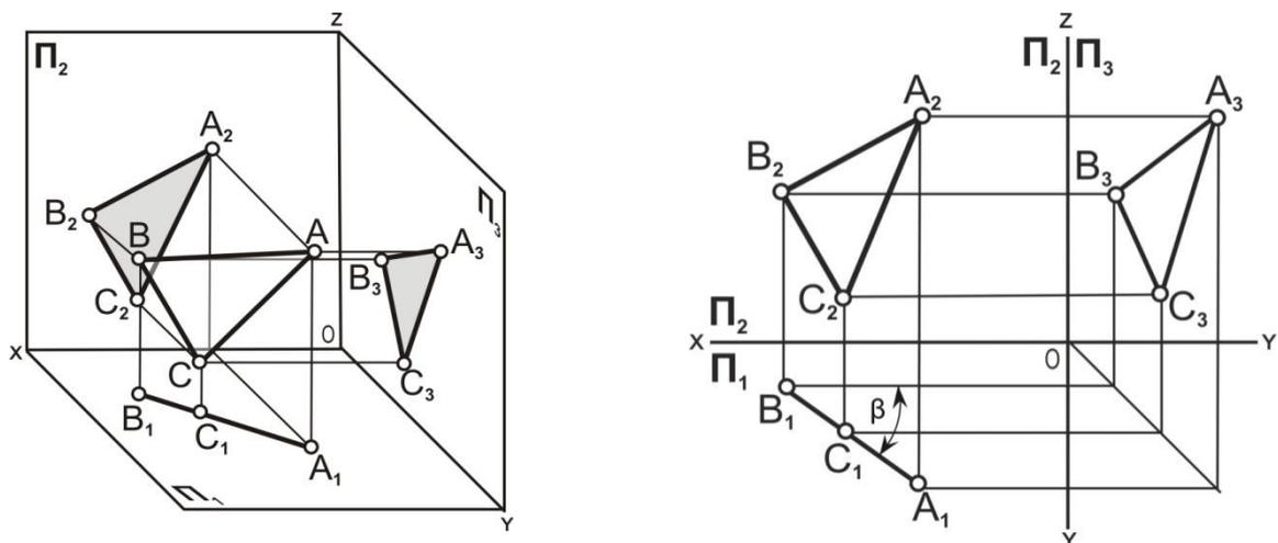
Рис. 5.8. Горизонтально-проецирующая плоскость: наглядное изображение и комплексный чертёж
