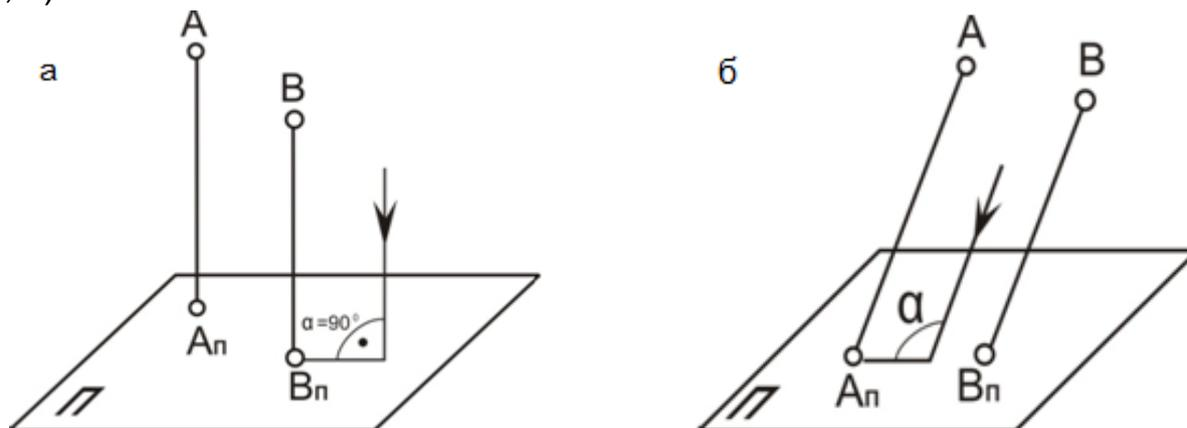
Рис. 1.5. Параллельное проецирование: а – прямоугольное проецирование; б – косоугольное проецирование
