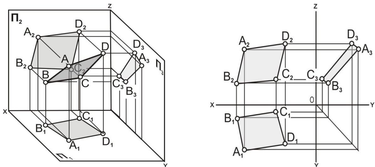
Рис. 5.5. Плоскость задана проекциями плоской фигуры ABCD: наглядное изображение и комплексный чертёж
