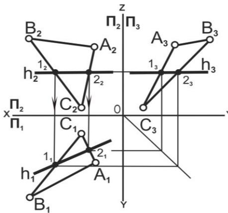
Рис. 5.16. Горизонталь плоскости
