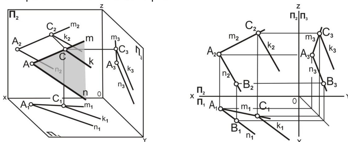
Рис. 5.15. Принадлежность прямой линии плоскости: наглядное изображение комплексный чертёж
