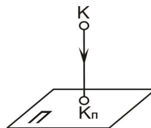
Рис. 1.6. Свойство 1. Проецирование точки
