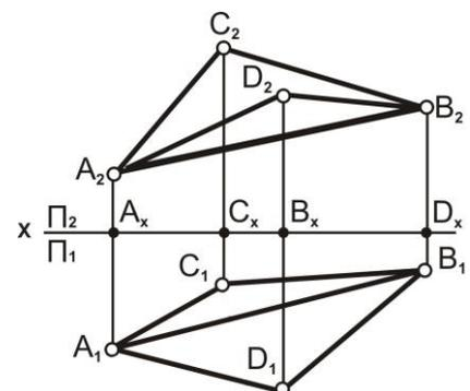
Рис. 6.25. Двугранный угол
