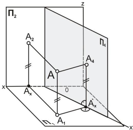
Рис. 6.1. Метод замены плоскостей проекций: наглядное изображение и комплексный чертёж
