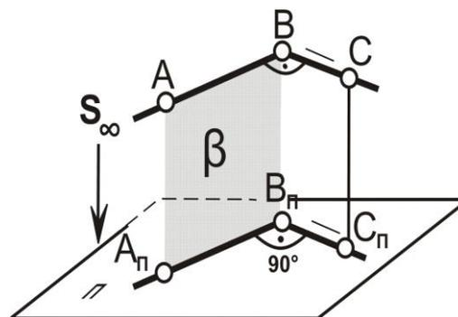
Рис. 1.14. Свойство 9. Проецирование прямого угла
