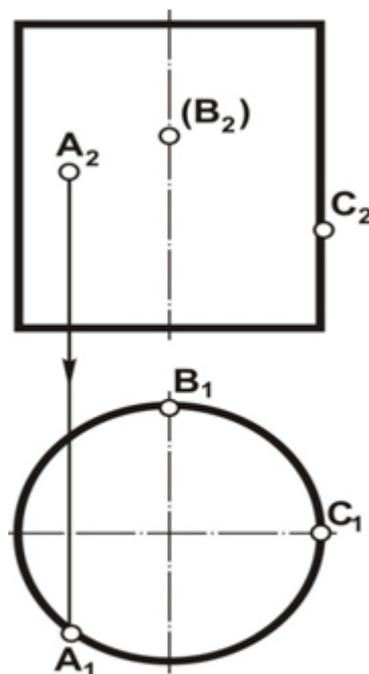
Рис.7.9. Точки на поверхности цилиндра
