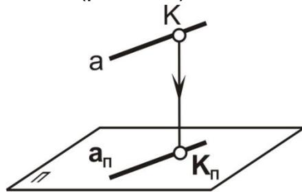
Рис. 1.8. Свойство 3. Проецирование точки, принадлежащей прямой
