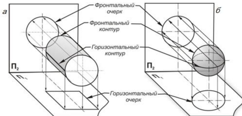
Рис. 7.2. Построение проекций поверхностей: а – цилиндрической; б – сферы
