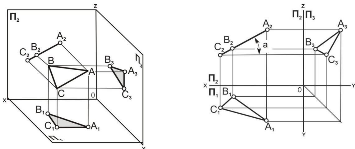
Рис. 5.9. Фронтально-проецирующая плоскость: наглядное изображение и комплексный чертёж
