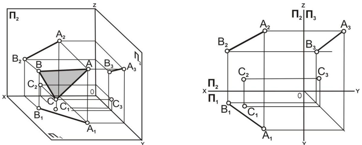
Рис. 5.4. Плоскость задана проекциями прямой линии  $AB$  и точки  $C$ : наглядное изображение и комплексный чертёж
