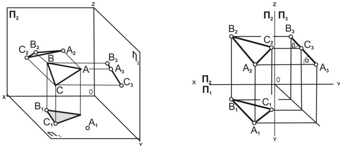
Рис. 5.10. Профильно-проецирующая плоскость: наглядное изображение и комплексный чертёж
