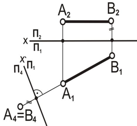
Рис.6.3. Преобразование прямой уровня в проецирующую методом замены
