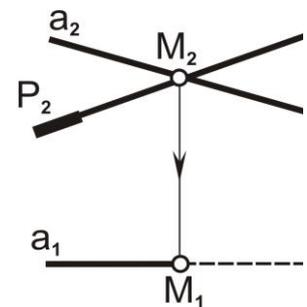
Рис. 5.22. Построение точки пересечения прямой общего положения с проецирующей плоскостью
