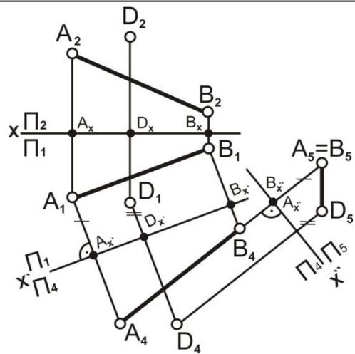
**Задача 9.** Дано: плоскость  $P(\triangle ABC)$  и точка  $D$  вне плоскости (рис. 6.29). Требуется: методом плоскопараллельного перемещения или вращением вокруг проецирующей прямой определить расстояние от точки до плоскости.
