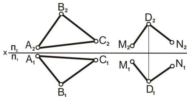
Рис. 5.21. Плоскости параллельные
