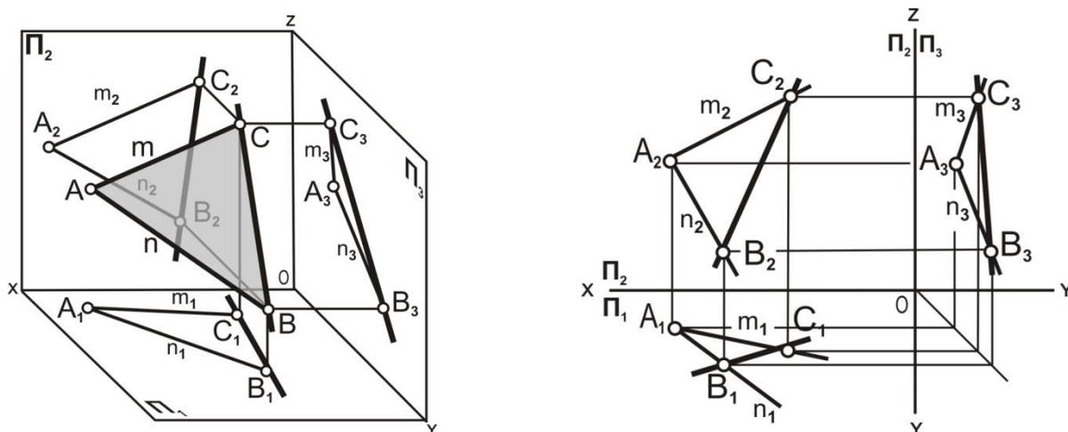
Рис. 5.14 . Принадлежность прямой линии плоскости: наглядное изображение и комплексный чертёж
