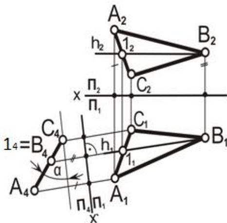
Рис. 6.4. Преобразование плоскости общего положения в плоскость проецирующую методом замены
