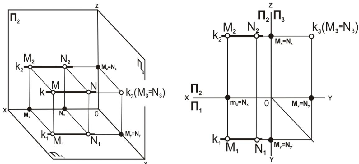
Рис. 4.8. Профильно-проецирующая прямая: наглядное изображение и комплексный чертёж
