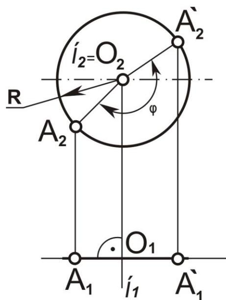
Рис. 6.6. Метод вращения вокруг проецирующей оси
