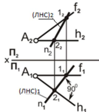
Рис.5.19. Построение линии наибольшего ската
