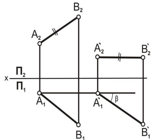
Рис. 6.7. Преобразование прямой общего положения в прямую уровня плоскопараллельным перемещением
