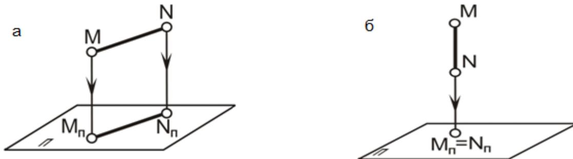
Рис. 1.7. Свойство 2. Проецирование прямой линии: а – общий случай; б – частный случай
