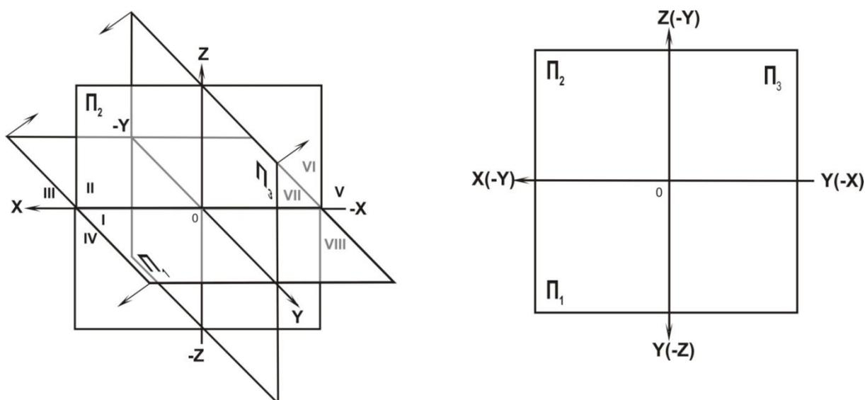
Рис. 2.4. Система плоскостей проекций  $\Pi_1\Pi_2\Pi_3$ : наглядное изображение и комплексный чертёж
