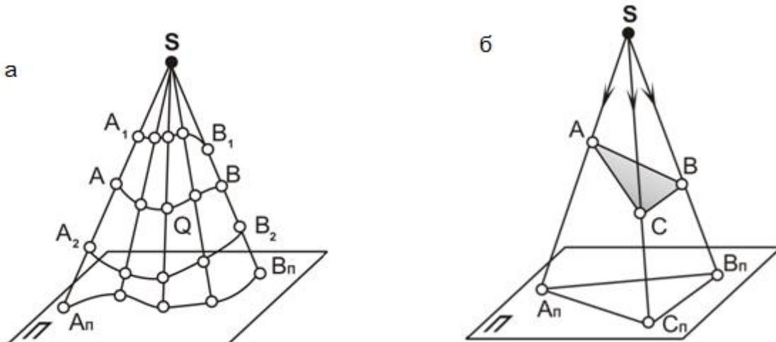
Рис. 1.4. Центральное проецирование геометрических объектов:
