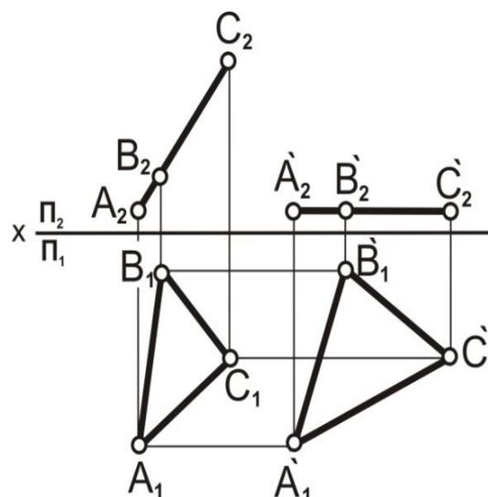
Рис. 6.10. Преобразование проецирующей плоскости в плоскость уровня плоскопараллельным перемещением
