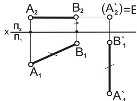
Рис. 6.8. Преобразование прямой уровня в проецирующую прямую плоскопараллельным перемещением
