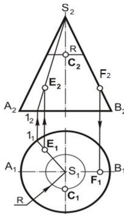
Рис.7.10. Точки на поверхности конуса
