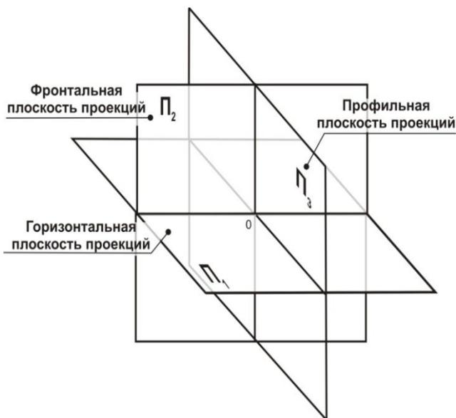
Рис. 2.2. Наглядное изображение системы плоскостей проекций  $\Pi_1\Pi_2\Pi_3$
