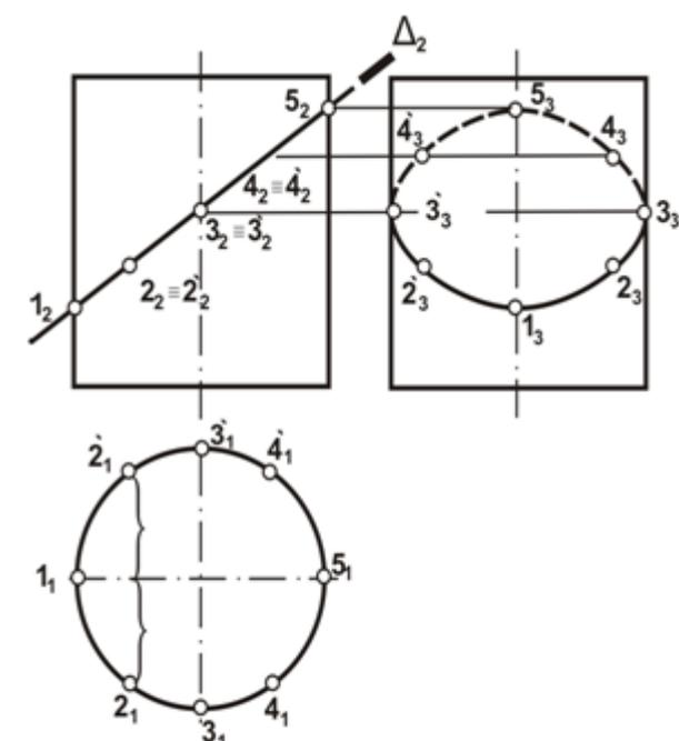
Рис.7.14. Сечение цилиндра плоскостью
