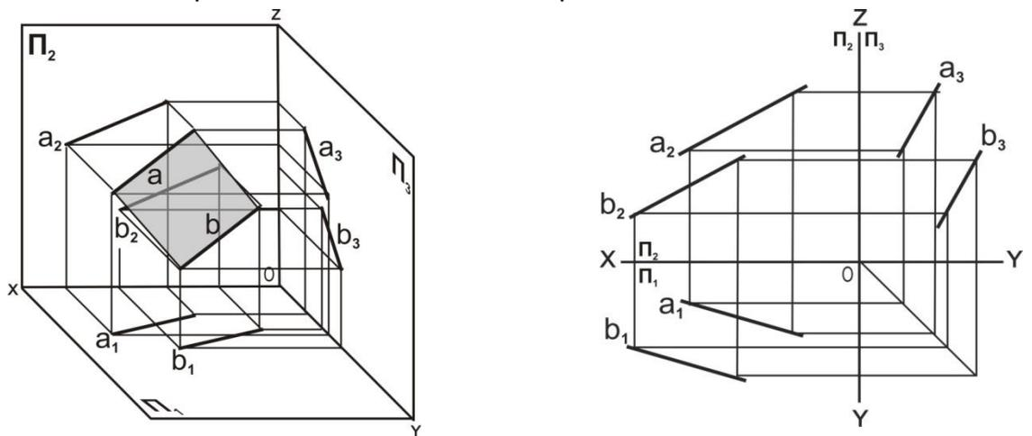
Рис. 5.3. Плоскость задана проекциями двух параллельных прямых  $a$  и  $b$ : наглядное изображение и комплексный чертёж
