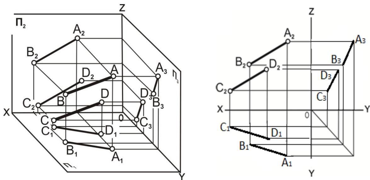
Рис. 4.10. Прямые линии, параллельные: наглядное изображение и комплексный чертёж
