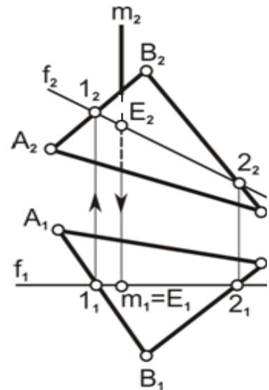
Рис. 5.23. Построение точки пересечения проецирующей прямой и плоскости общего положения
