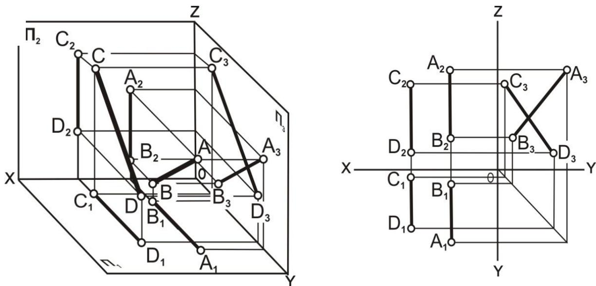
Рис. 4.11. Прямые линии, непараллельные: наглядное изображение и комплексный чертёж
