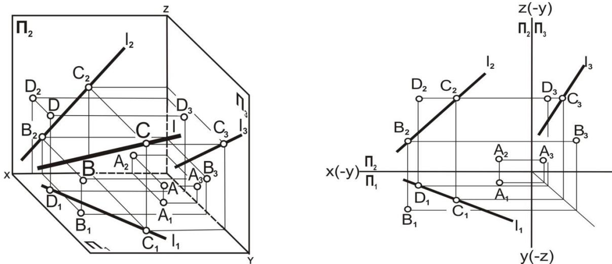
Рис. 4.16. Взаимное положение прямой линии и точек: наглядное изображение и комплексный чертёж
