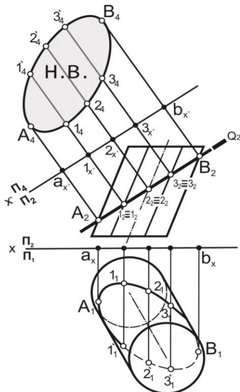
Рис. 7.25. Определение натуральной величины сечения цилиндрической поверхности плоскостью методом замены плоскостей проекций
