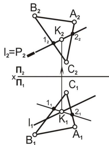
6. Определить видимость прямой линии l при помощи конкурирующих точек.
