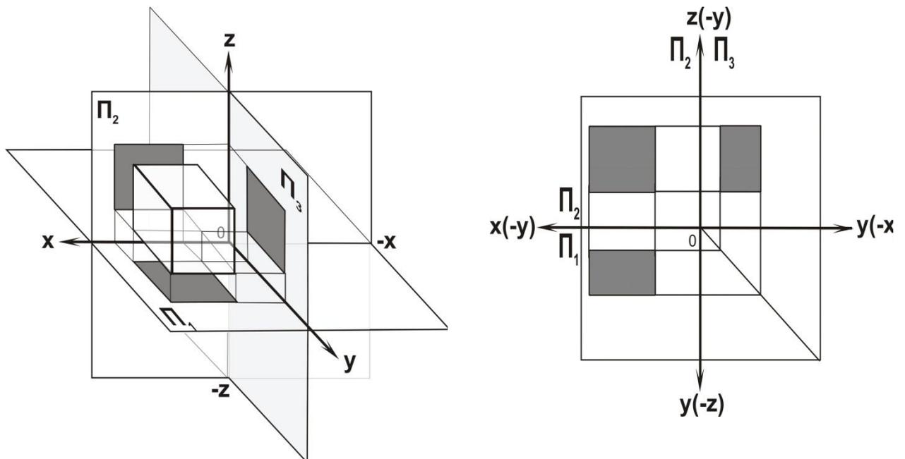
Рис. 2.5. Проецирование призмы в системе плоскостей проекций  $\Pi_1\Pi_2\Pi_3$ : наглядное изображение и комплексный чертёж
