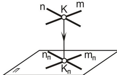
Рис. 1.9. Свойство 4. Проецирование пересекающихся прямых линий
