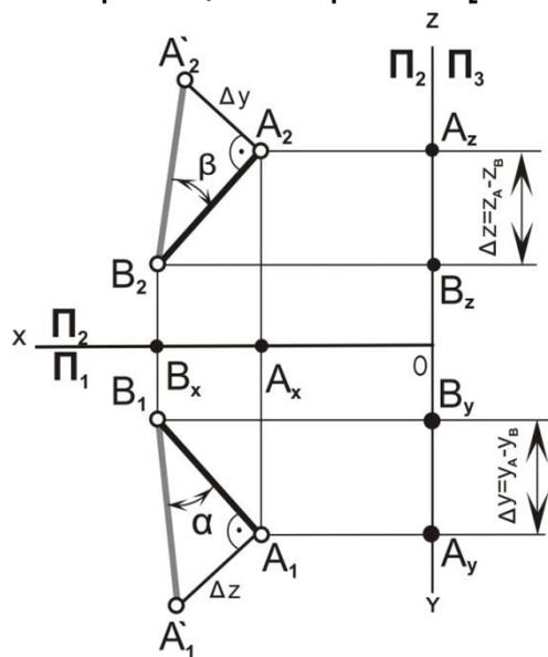
Рис. 4.9. Определение натуральной величины отрезка
