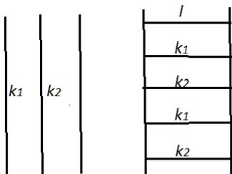
30.\* Две стенки  $A$  и  $B$  одинаковой толщины составлены из разнородных металлов, так как это указано на рис. 7.9. В каком случае теплопроводность стенки больше? (Ответ: в первом случае).
